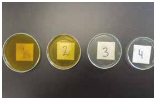
Gambar 5.43 – Perbedaan Warna Larutan Sisa Pembersihan Korosi pada Arca Lokanatha setelah Empat Kali Penggantian Lap Chamois yang Diberi Larutan Seskuikarbonat
