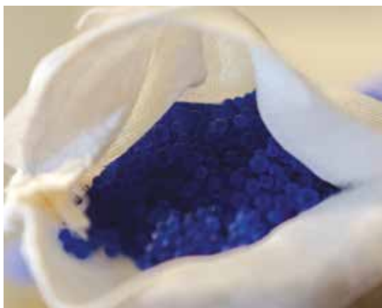
Gambar 5.15 – Desikan Gel Silika Biru (Kiri) akan Berubah Warna Menjadi Merah Muda (Kanan) setelah Jenuh
