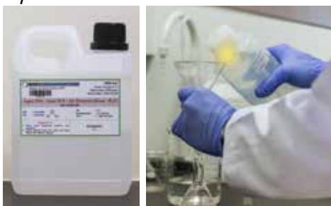
Gambar 6.61 – Melarutkan Padatan \text{AgNO}_3
