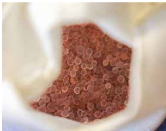
Gambar 5.15 – Desikan Gel Silika Biru (Kiri) akan Berubah Warna Menjadi Merah Muda (Kanan) setelah Jenuh
