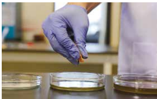
Gambar 5.43 – Perbedaan Warna Larutan Sisa Pembersihan Korosi pada Arca Lokanatha setelah Empat Kali Penggantian Lap Chamois yang Diberi Larutan Seskuikarbonat
