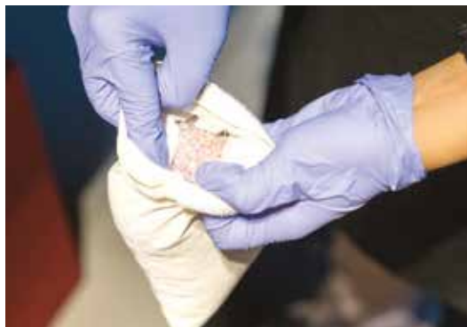
Gambar 6.28 – Gel Silika yang Telah Melewati Masa Optimum Penggunaan
