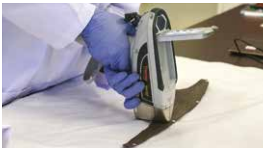
Gambar 6.17 – Identifikasi Unsur Korosi dengan Menggunakan XRF
