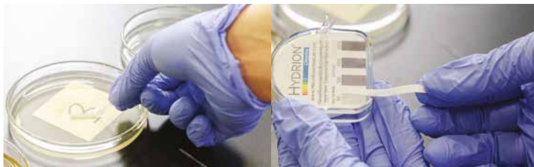
Gambar 5.45 – Konfirmasi Keberadaan Ion Klorida dari Larutan Sisa Pembersihan Arca Lokanatha Menggunakan Kertas Tes Klorida
