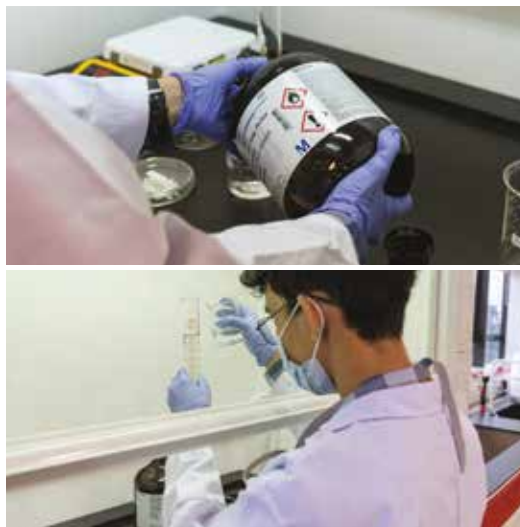
Gambar 6.76 – Membuat Larutan BTA 3% dengan Mencampurkan 15 Gram BTA dengan 500ml Etanol
