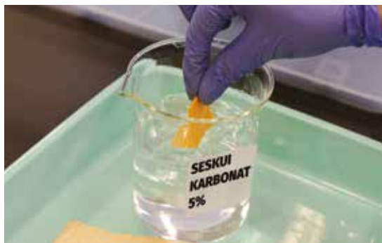
Gambar 5.42 – Aplikasi Larutan Seskuikarbonat pada Titik Korosi Aktif di Arca Lokanatha
